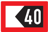
Fahrwassereinengung, Abstand in Metern, in dem sich Fahrzeuge vom Tafelzeichen entfernt halten sollen
